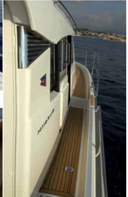
Encastré et plus large que sur bâbord le passavant tribord sera privilégié lors des déplacements.
