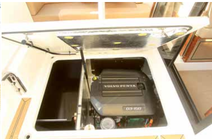
La motorisation Volvo Penta à ligne d'arbre est accessible dans le cockpit extérieur via une grande trappe de plancher.
