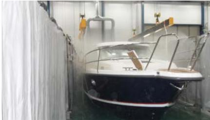
Jedes Boot welches bei Nimbus die Halle verlässt, wird umfangreichen Qualitätstests und einer Endkontrolle unterzogen. So wird auch jede Nimbus nicht nur auf Dichtigkeit im
