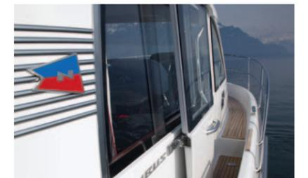
Die erwähnte Schiebetüre und das dank dem asymmetrisch gebauten Aufbau besonders breite Gangbord auf der Steuerbordseite sind besonders auffällige Merkmale der Nimbus 335 Coupé. Erst auf den zweiten Blick sichtbar ist die qualitativ hochwertige Bauweise im Vakuum-Infusionsverfahren. Die Passgenauigkeit der einzelnen Bauteile ist hervorragend und sämtliche Teile sind auch auf der Innenseite glatt und sauber.
