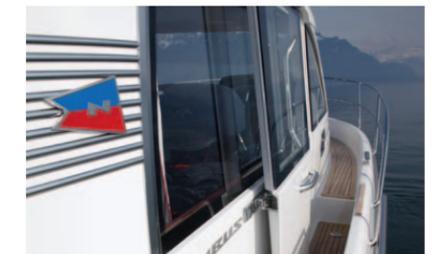
La porte coulissante et le passavant particulièrement large du côté tribord sont des caractéristiques remarquables du Nimbus 335 Coupé. Dans un deuxième temps, c'est la qualité de la construction que l'on ne manquera pas de relever, notamment la méthode d'infusion sous vide. L'ajustement des divers éléments est excellent et la finition des aménagements intérieurs impeccables. Pour les amoureux du travail bien fait.
