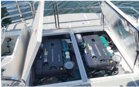
Gut zugänglich und prall gefüllt: Der Motorraum des Testschiffes mit Volvo Penta D4-300 Doppelmotorisierung.
